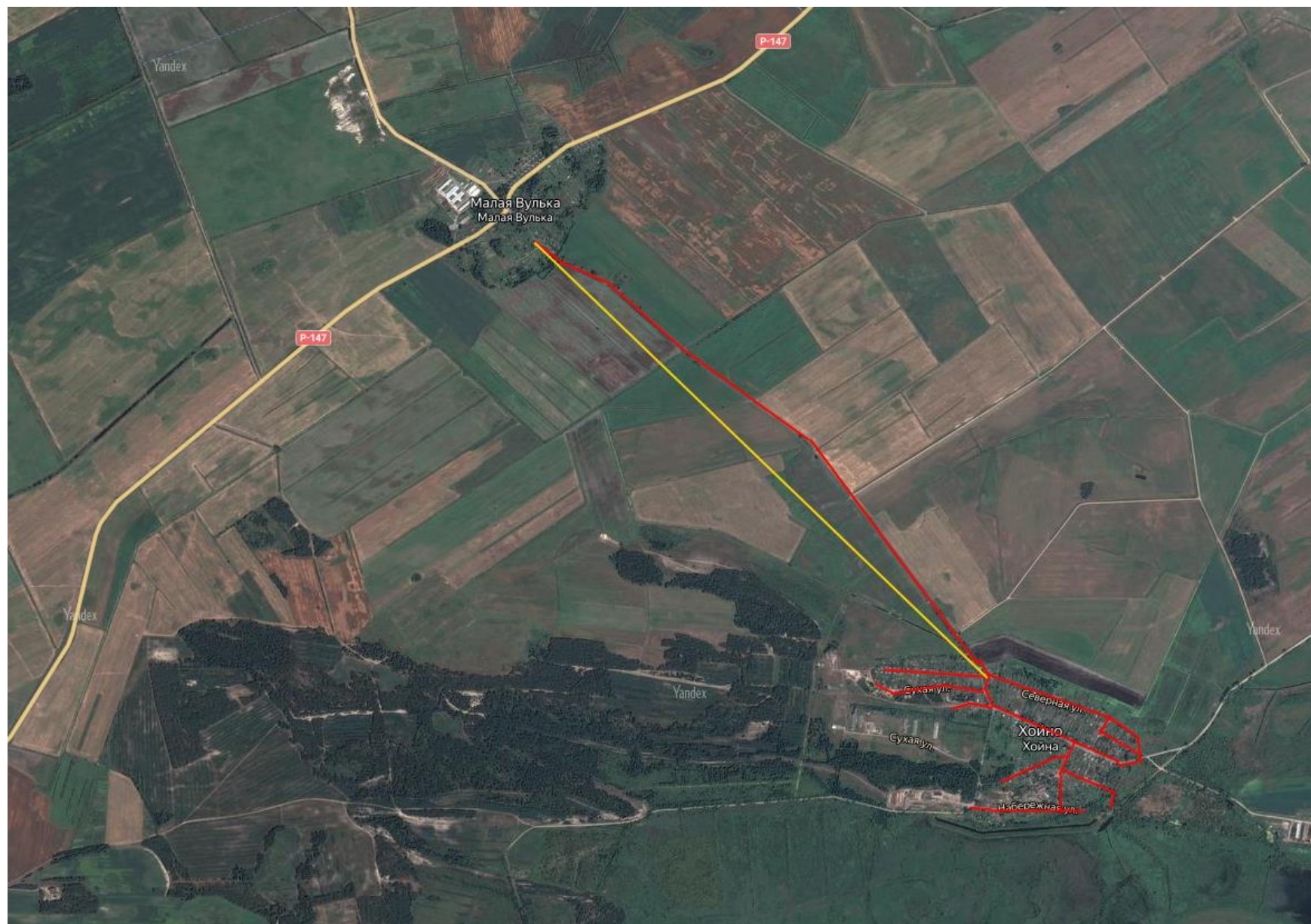
Рисунок 2.1 – Обзорная схема расположения трассы проектируемого газопровода (красная линия – основной вариант, желтая линия – альтернативный вариант)
