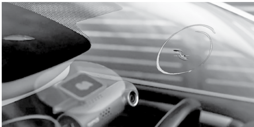
Не допускается к участию в дорожном движении транспортное средство, ветровое стекло которого имеет трещину (трещины) со стороны водителя в зоне, очищаемой стеклоочистителем. Это тот самый случай, когда размер (щеток омывателя) имеет значение
