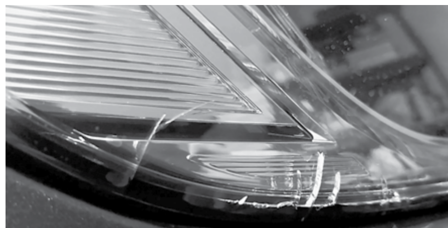
Не допускаются отсутствие, разрушение и загрязнение рассеивателей фар или установка в них элементов, которые конструкцией не предусмотрены, как и повреждения и отслоения светоотражающей маркировки
